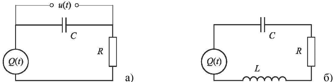
Рис. 3. RC-цепь и RCL-цепь с генераторами импульсов
